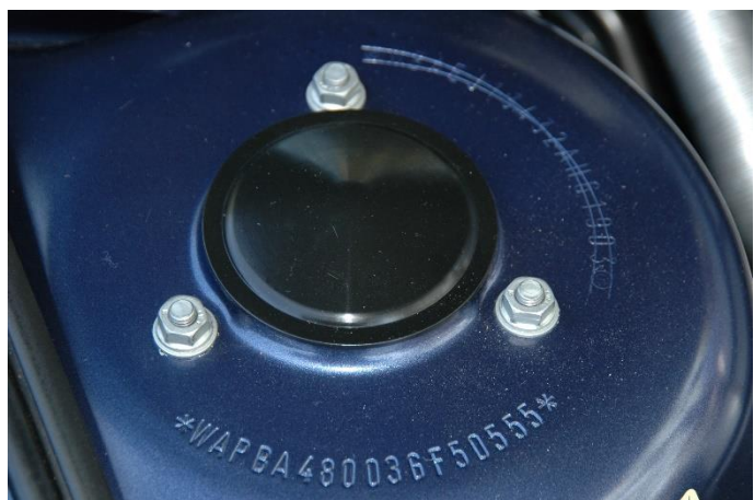
5 Die VIN des letzten Alpina V8, oben die entwertete BMW-VIN, unten die Alpina-VIN
