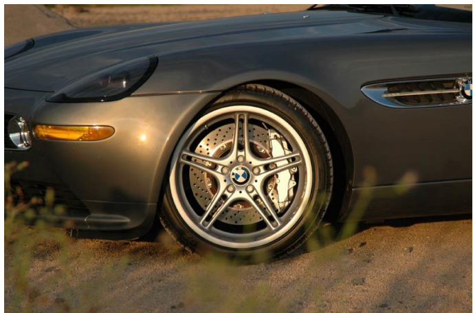
13 Brembo 8-Kolben-Bremse, 380mm mit Racing Dynamics Felge 19"
