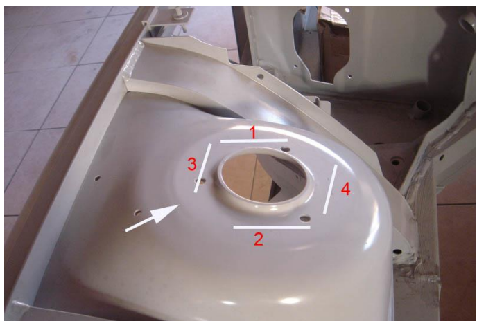
21 Die Linien zeigen, wo das Lineal aufliegen muss. Zum Rand fällt der Dom ab, innerhalb des Lochkreises steigt er an.
