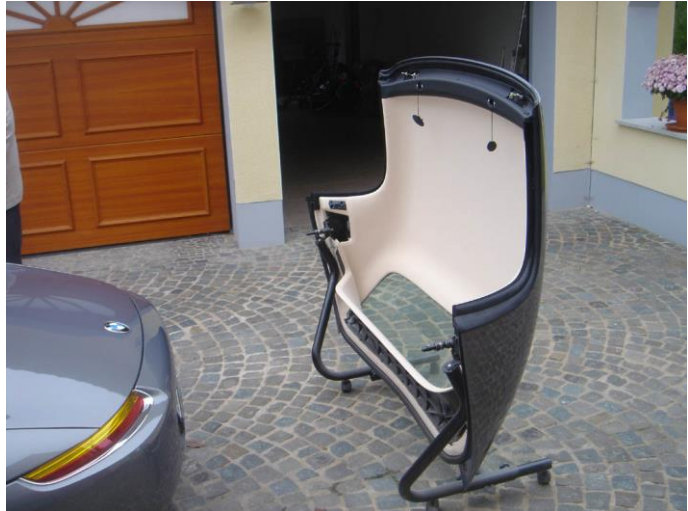
14 Hardtop auf dem Ständer. Man beachte die herabhängenden Abdeckungen für die Befestigung am Frontrahmen.
