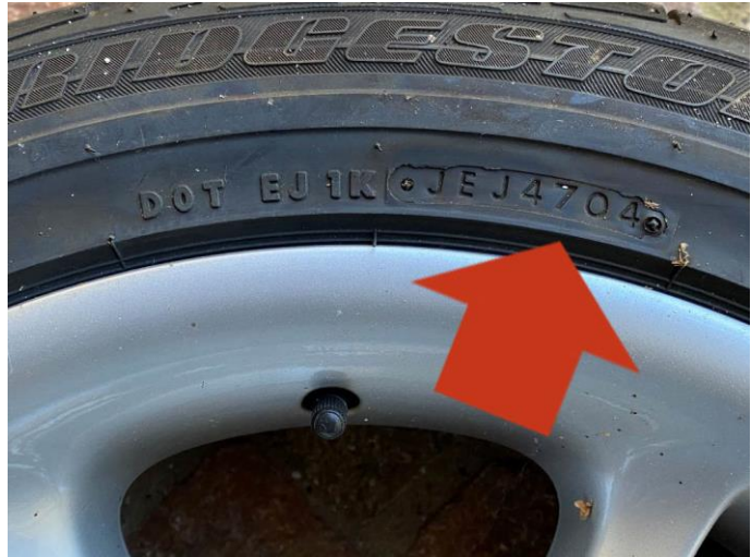
24 Die DOT-Kennzeichnung lautet 4704, also 47. Kalenderwoche in 2004. Mit einem derart alten Reifen zu fahren ist unverantwortlich.
