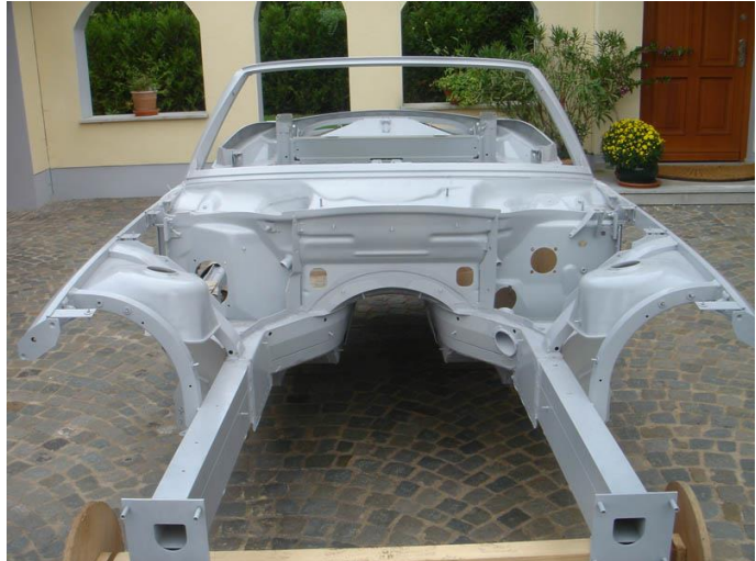
20 Am nackten Rahmen sind die Dome für die Vorderradaufhängung gut zu erkennen.
